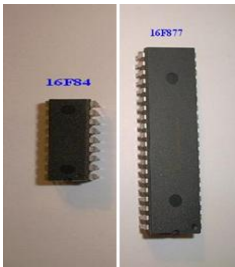
Figure 2 : La différence entre le PIC16f84 et le PIC 16f877
